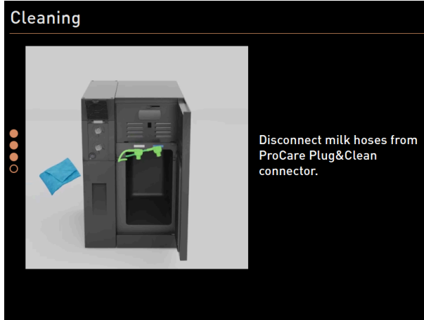
Şekil: Süt hortumlarının Plug&Clean bağlantılarından çıkartılması
