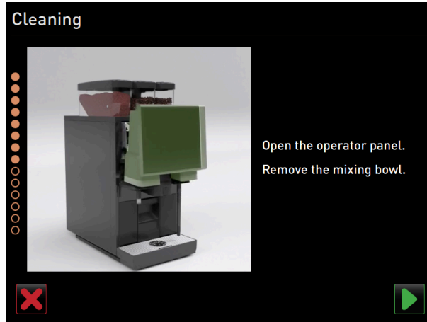
Şekil: Kontrol panelinin kaldırılması
