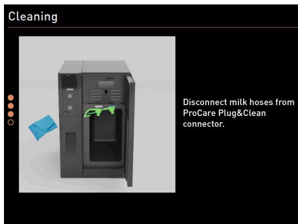
図: Plug&Clean接続部からミルクホースを取り外す
