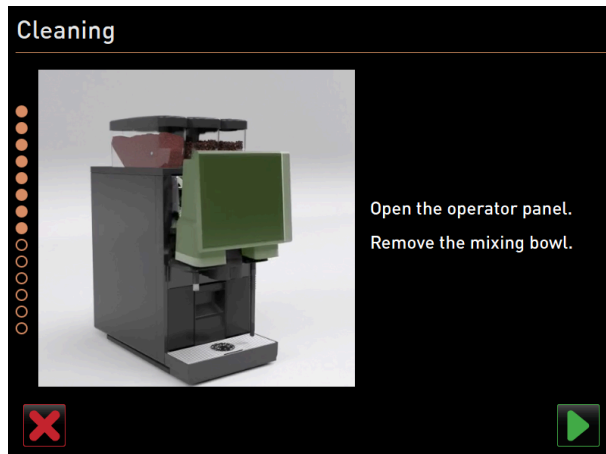
Рисунок: Подъем панели управления
