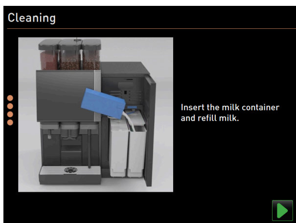
Fig.: Colocación del depósito de leche
