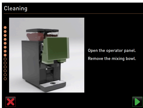
Fig.: Retirada del panel de operación
