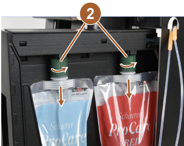
Fig.: Retirada de las bolsas de limpieza
