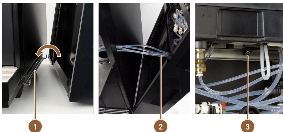
Afbeelding: ProCare-unit met aan machine bevestigen
