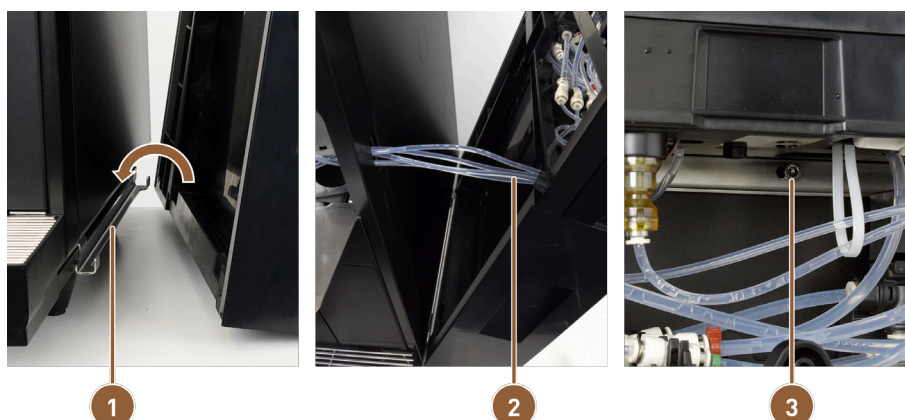
Figur: Feste ProCare-enheten til maskinen
