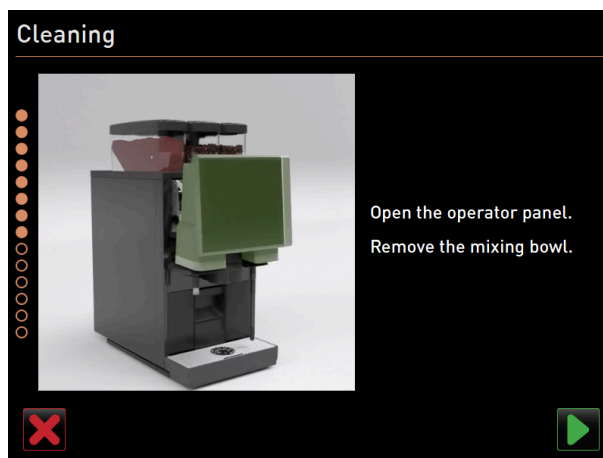
Figur: Løfte betjeningspanel
