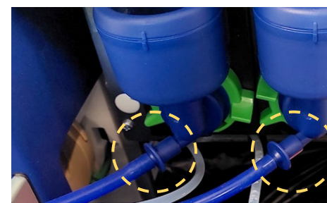
Wordt een instant drank (melk, cacao, of suiker) niet uitgegeven nadat de drank is geselecteerd: controleer de uitloopslang van de mixerbeker(s), en sluit aan indien van toepassing.
