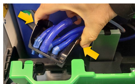
Neem de houder van de uitloopslangen uit het frame. (druk aan weerszijde om het te ontgrendelen)
