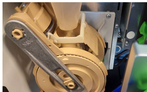
Inspecteer de brewer. (op eventuele vervuiling, correcte plaatsing)
