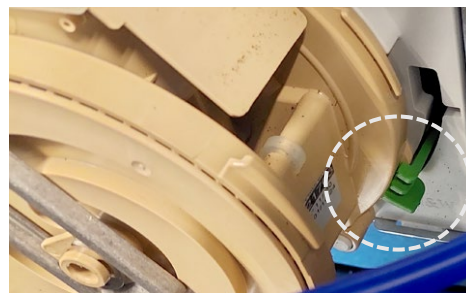
Druk op de groene ontgrendeling, en neem de brewer uit de machine. Controleer of de brewer vrij kan bewegen en/of schoon is.
