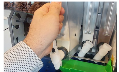
Druk de uitloop van de desbetreffende container naar boven, en neem de container uit de machine.
