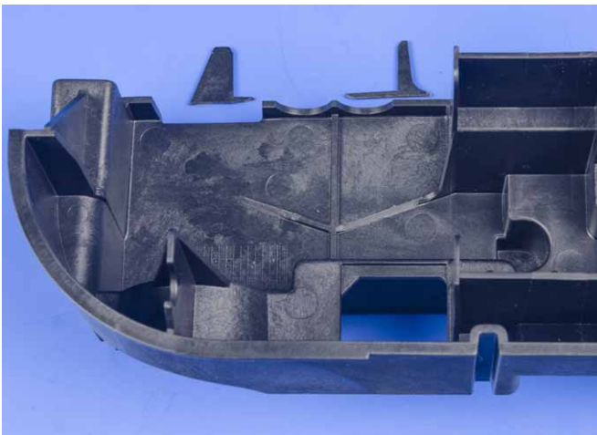
Heckrahmen mit herausgebrochenen Stützrippen
