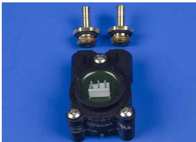
Altes Flowmeter mit demontierten Einschraubstutzen und O-Ringen
