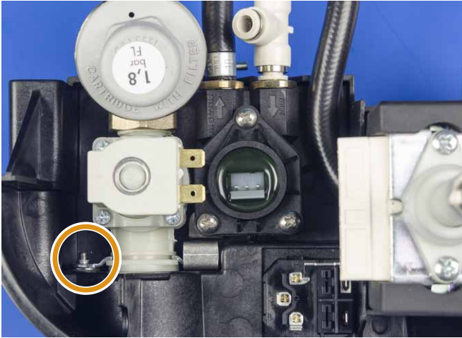
Ersatzteilset Flowmeter eingebaut
