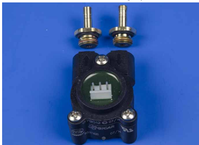
Caudalímetro antiguo con los racores roscados y las juntas tóricas desmontados
