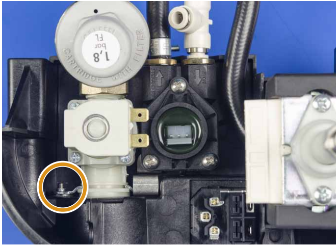
Kit de caudalímetro de repuesto instalado
